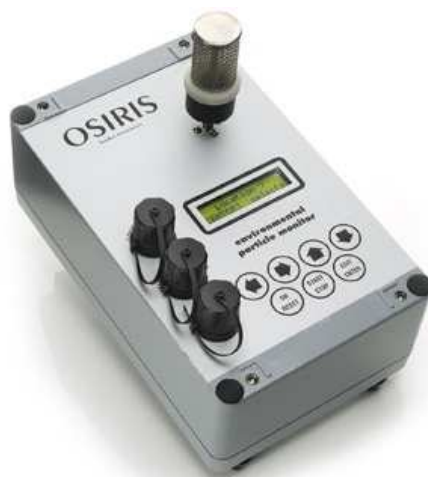
Рис. 4.2: Прибор для непрерывного измерения концентрации частиц в атмосферном воздухе Osiris производства компании Turnkey
