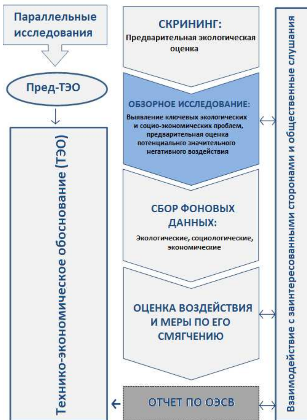
Рис. 2.1: Процесс выполнения ОЭСВ
